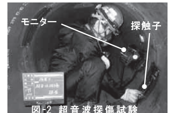
図-2 超音波探傷試験
