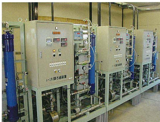
写真-2 膜ろ過実験施設 (写真提供: 水道産業新聞社)
