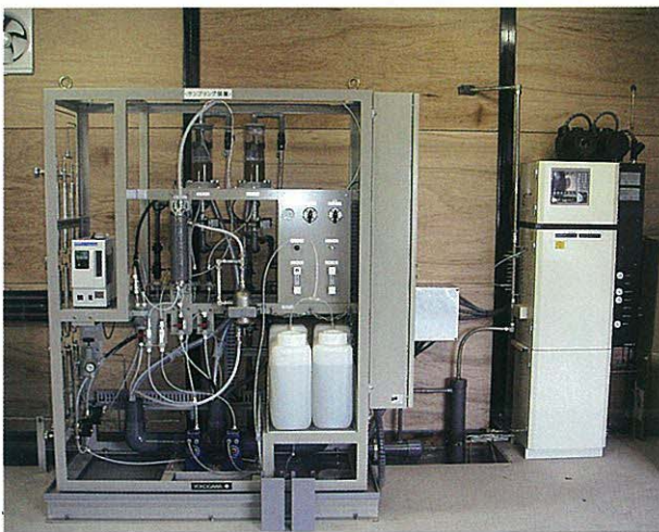
写真-3 VOC 測定装置
