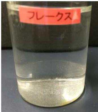
水道水中のミネラル分であるマグネシウムとガラス容器のケイ酸が高温水中で反応し、生成されたケイ酸マグネシウムが、ガラス面に付着します。付着したケイ酸マグネシウムは、この反応を繰り返すことで、どんどん厚くなり、最終的に剥離したものが、フレークスです。
