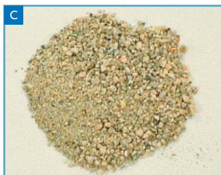
C 比重2.4~2.6程度 4.0mmふるい通過95%以上の砂を使用
