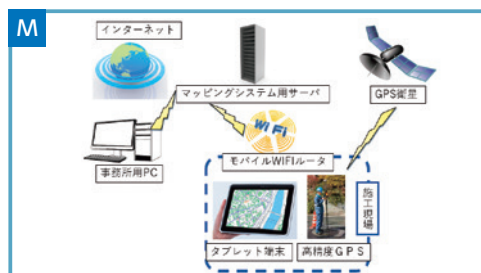
M ICTを活用したフィールドテスト環境と使用機器構成
