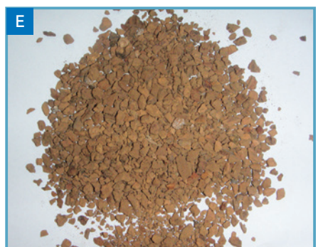
E 比重3.2程度 老朽化したダクタイル管より採取した物を磨り潰し、粒径1.0~5.0mmの物を使用
