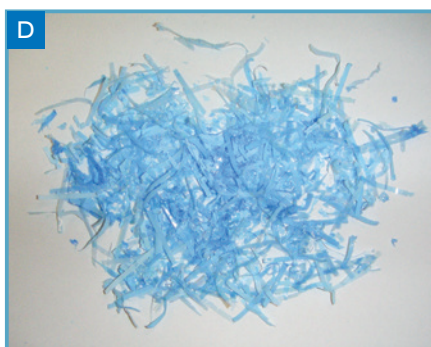
D 比重1.14 厚さ25 \mu mのアクリルシートに着色しシュレッダーにて細断したものを使用
