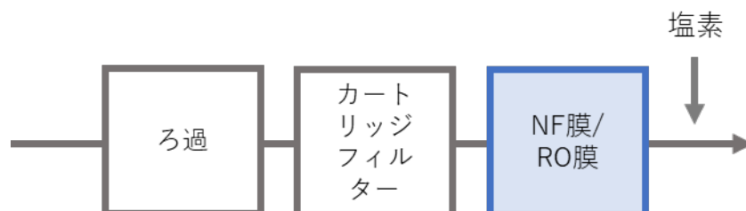
図 4 NF 膜又は RO 膜を導入した浄水処理フローの例
