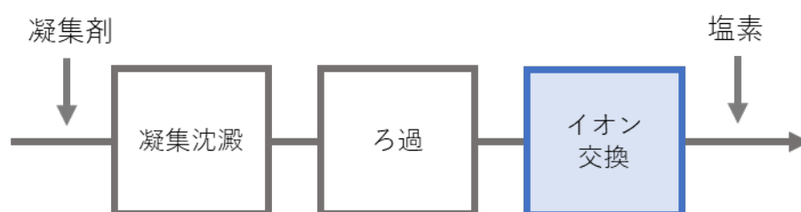
図 3 イオン交換樹脂を導入した浄水処理フローの例
