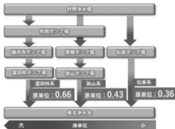
図4 東部・南部送水ルート (単位: kWh/m 3 )
