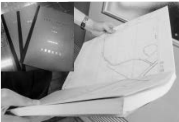
写真2 漏水事故現場等に持ち込む製本された水道管管理図
