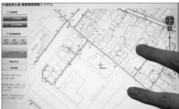
図6 水道管管理図上のタッチパネル操作
