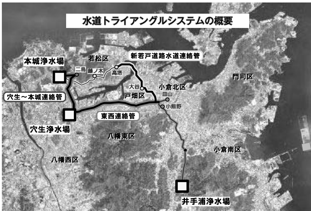
図2 水道トライアングルシステムの概要
