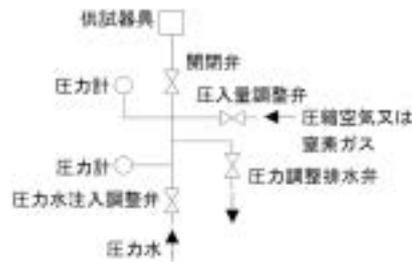
図3 作動確認試験装置例
