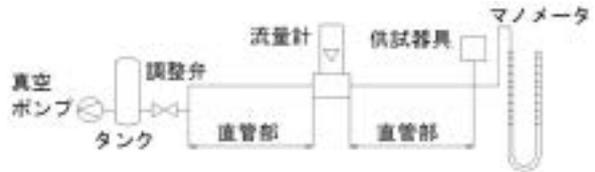
図2 吸気性能試験装置例
