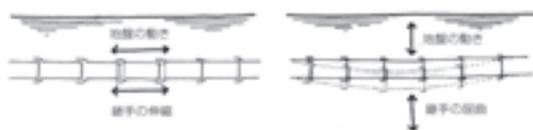
図2 柔構造管路
