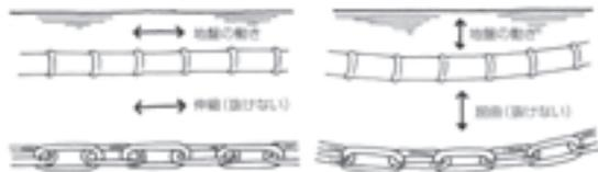
図1 鎖構造管路
