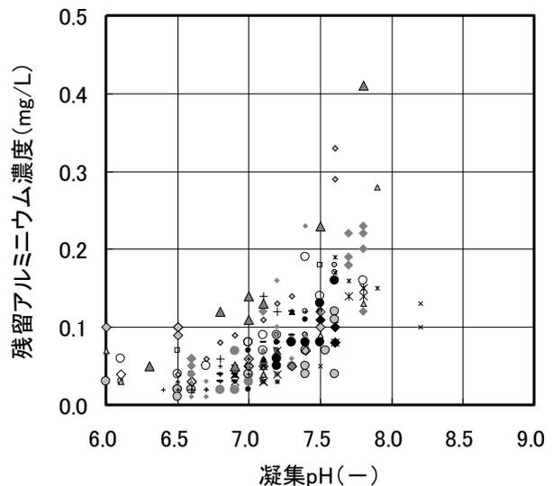
図 1 凝集 pH と残留アルミニウム濃度の関係<sup>2)</sup>
