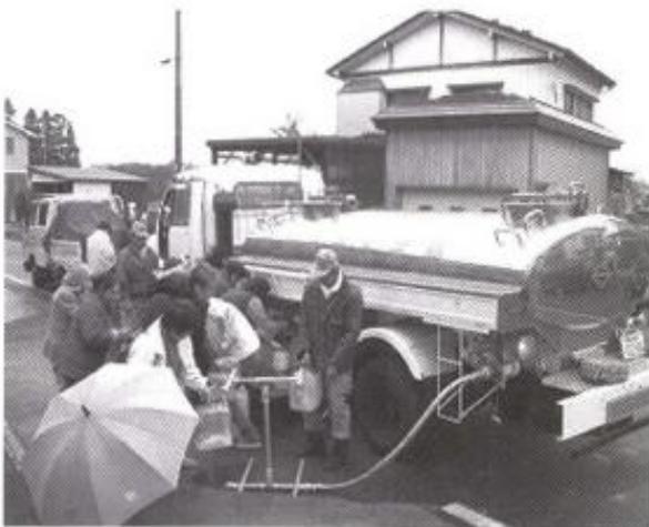
▲給水車による運搬給水の例
