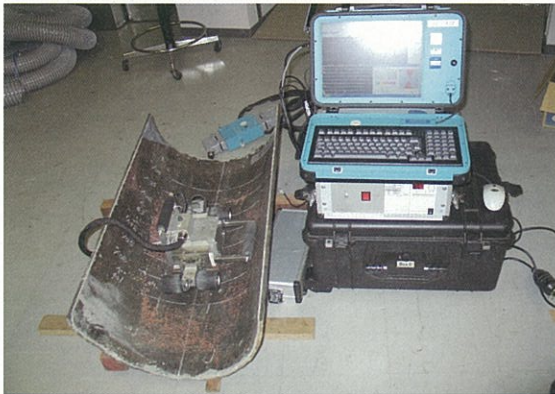
写真2 磁気飽和過流探傷法試験装置
