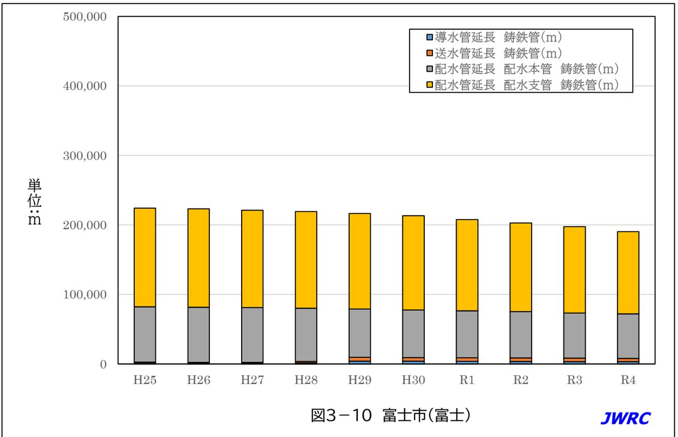
(参考)規模の大きい水道事業体における铸铁管の残存延長の推移
