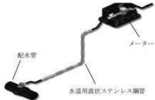
図2 配水管からメーター間の配管例
