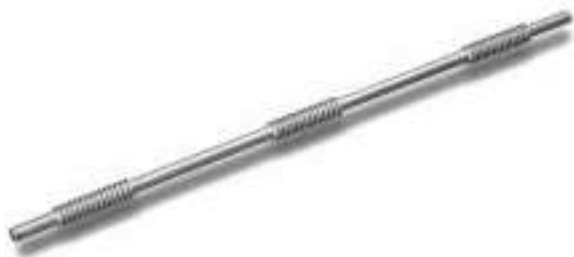
図1 水道用波状ステンレス鋼管外観 ※実際の製品は全長4,000mm、波状部が8連になります。
