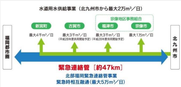
北部福岡緊急連絡管/水道用水供給事業
