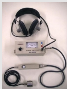
←日本製資器材の活用 （漏水発見器等）
