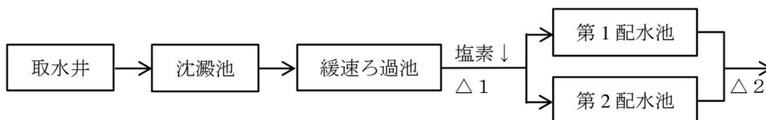
図 4-5 現状の浄水処理フロー(A 浄水場)
